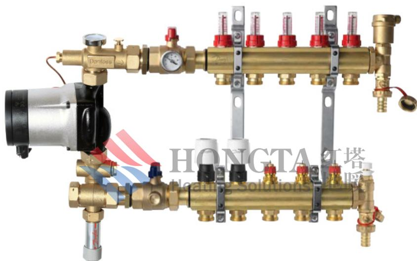
紧凑型混水中心 + 内置有流量计和具有独一无二的阻力预调功能控制阀的FHF系列分集水器，确保快速、轻松地实现水力平衡
