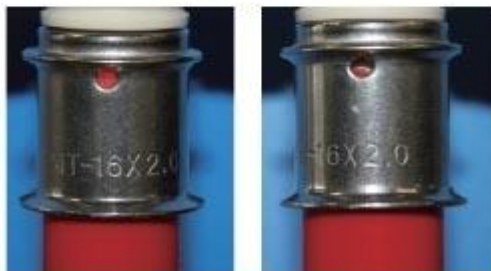
(a)管端正确插到位 (b)管端未插到位
